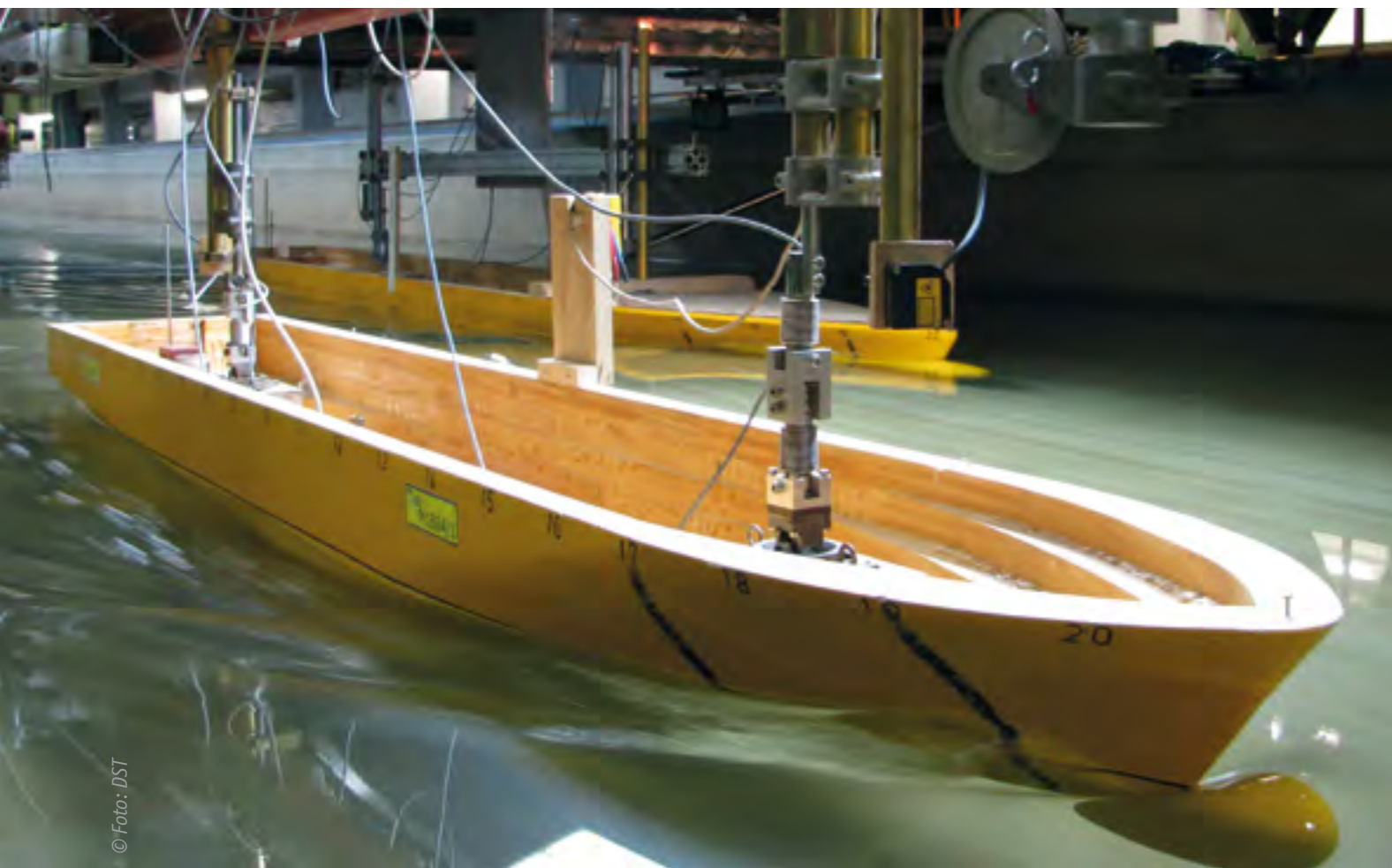
Modellversuch im Schlepptank Model test in the towing tank
