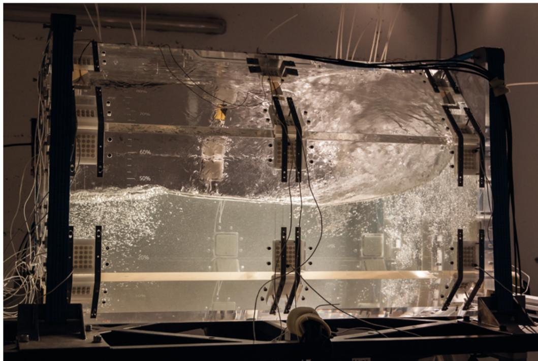
Schwappende Flüssigkeit kann teilgefüllte Tanks – z.B. für tiefkaltes Flüssiggas im Schiffstransport – zerstören.
