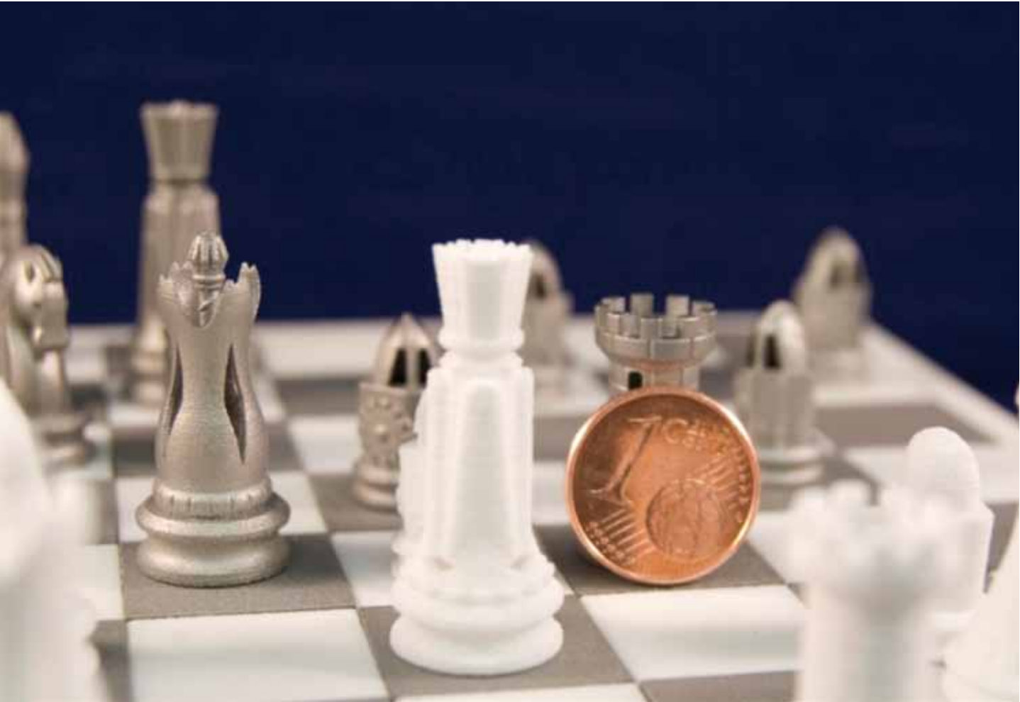
Schachfiguren als Beispiel additiver Fertigung: „Schwarz“ aus Metall, hergestellt durch Laser-Strahlschmelzen, „Weiß“ aus Kunststoff, durch Laser-Sintern
