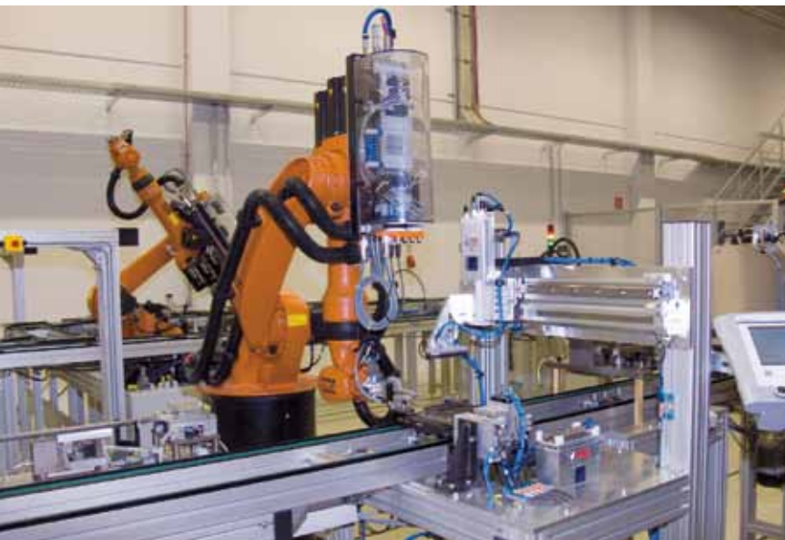
Blick in die Assemblierungslinie für Brennstoffzellen View into the assembly line for fuel cells
